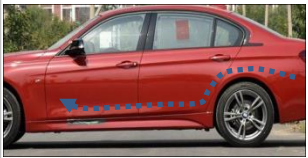
3.13 布开关线：穿过后门迎宾踏板胶条内侧延伸至主驾驶室预留合适线束连接，如图虚线示意
