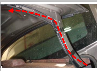
3.5 布线 把 2 扎布线束(接开关、接门锁信号、)从尾箱右侧沿着摇臂延伸到上门锁(虚线)，图片仅供参考
