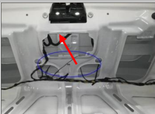
3.16 中控开关接线位置：接控制线（原车尾门上开关插头）箭头示意位置
