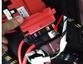
3.11 接正极电源：用我司配的正极安装在原车正极螺栓上，拧紧
