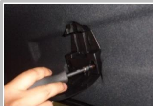
3.4 用螺丝刀把螺丝松开，取下塑料件，并妥善保管；(箭头)
