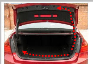
3.6 信号线布置到上门锁，右撑杆电机线沿着后踏板底部把线布置到右侧连接右撑杆；
