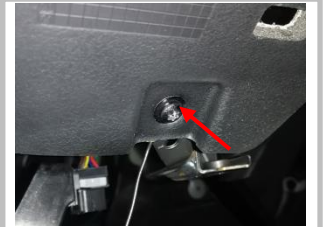
3.15 接中控开关负极：拆开 A 柱接到原车钣金上
