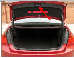
3.7 接尾门状态信号线：把信号线引到上门锁扣位置，用与连接原车信号线；
