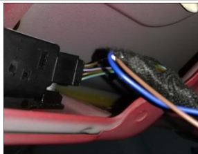
3.8 接尾门状态信号线：把连接上门锁的接头拔下，注意如图拍摄角度
