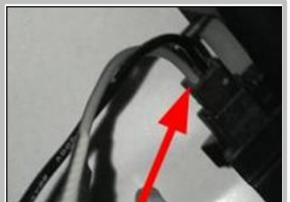
3.18 接中控开关控制线：在原车尾门上开关插头看到灰黄线（插头1脚），连接中控开关控制线
