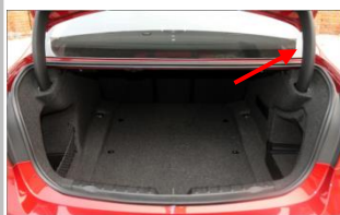
3.5 拆卸塑料扣，原车摇臂上的塑料件拆下，
