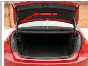
3.1 拆卸上门锁盖板，然后把线束如虚线穿到上门锁盖板；
