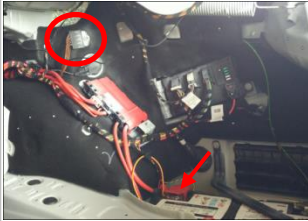
3.10 看到原车右侧尾箱内部电瓶，我司正极线接原车电瓶正极，圆圈位置为负极
