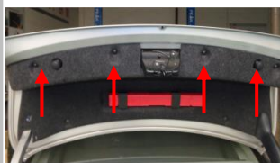
3.2 把撑杆上的塑料扣或螺钉拆下，并妥善保管；把尾箱盖板往下轻拍，然后取下后尾箱盖板，并妥善保管；(箭头)
